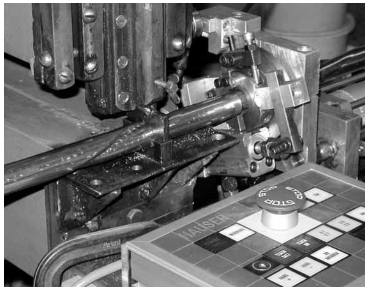
oben: Presse zur Rohrherstellung links: Spiralrohr Durchmesser 22mm
